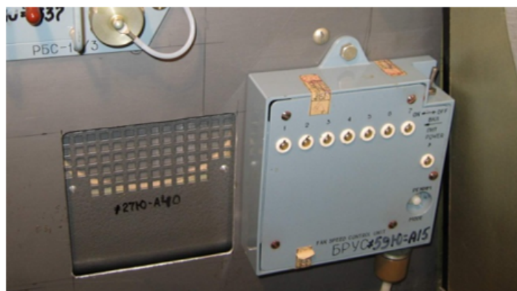
Рисунок 33 – Блок регулировки угловой скорости вращения вентилятора
