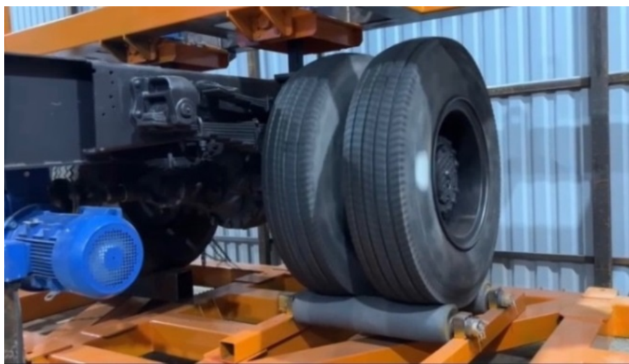
Рисунок 4 – Фото стенда испытания полимерных роликов
