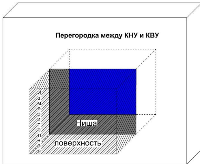
Рис. 1. Измерительная поверхность в виде прямоугольного параллелепипеда (заштрихованная область), охватывающая нишу (серая область) со смонтированным в ней испытуемым объектом (синяя область)
