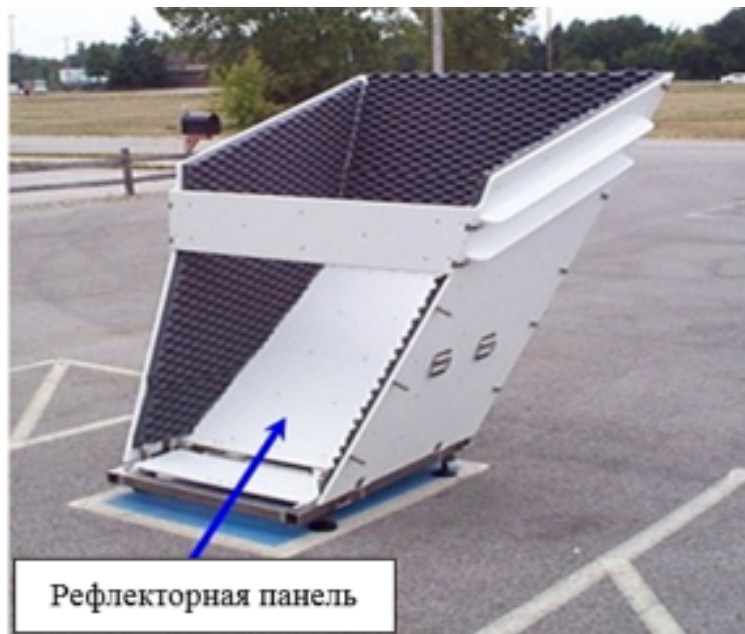
Рисунок 10 – Рефлекторная панель содара VT-1 в корпусе антенны
