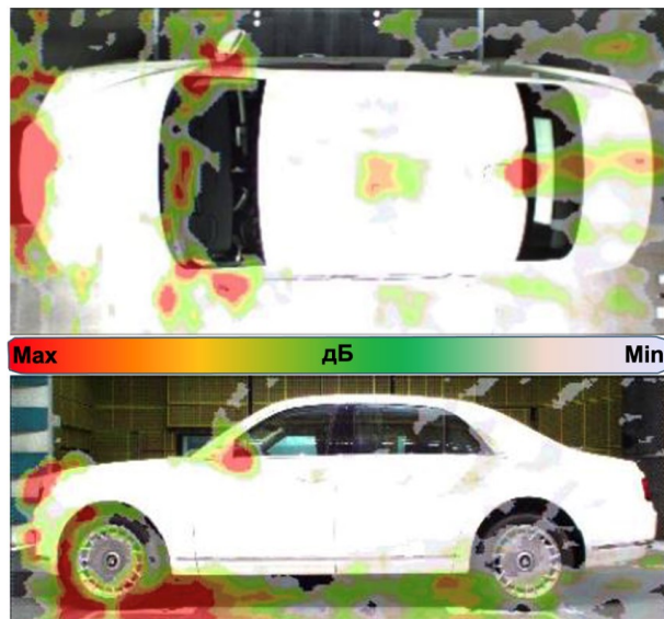
Рис. 7. Результаты экспериментальных исследований аэроакустических характеристик при скорости потока 140 км/час на частотах: 1600 Гц – а, 2500 Гц – б и 3150 Гц – в
