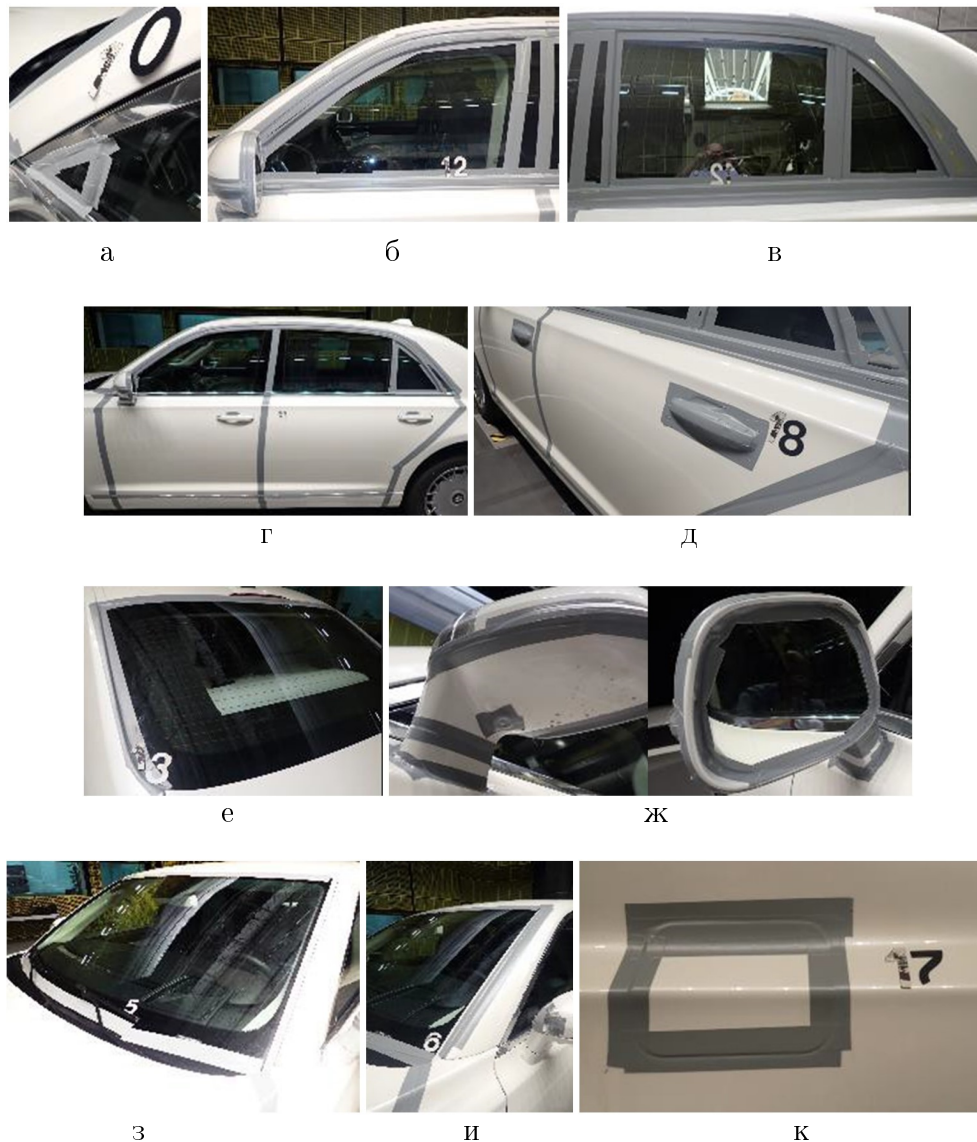
Рис. 15. Оклеены экстерьерные элементы АТС: а – передние боковые неподвижные стекла, б – желобки передних опускных стекол, в – желобки задних опускных стекол и задние боковые неподвижные стекла, г – передние и задние двери, д – дверные ручки, е – периметр заднего окна, ж – боковые зеркала заднего вида, з – периметр ветрового стекла, и – водосток и к – лючок бензобака
