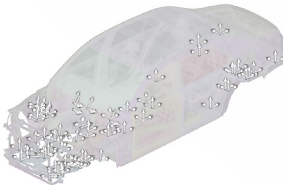
Рис. 2. Места приложения сил в КЭМ зеленого кузова для исследования ФПШ
