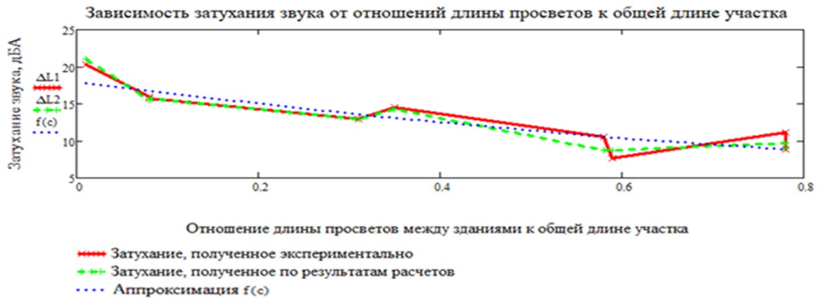
Рис. 5. Зависимость затухания звука в застройке от длины проветров между домами к общей длине рассматриваемого участка
