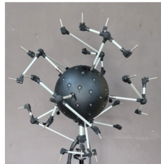
б) расширенная конфигурация, внешний диаметр сферы 80 см, 78 микрофонов. Рабочий частотный диапазон 200-10000 Гц
